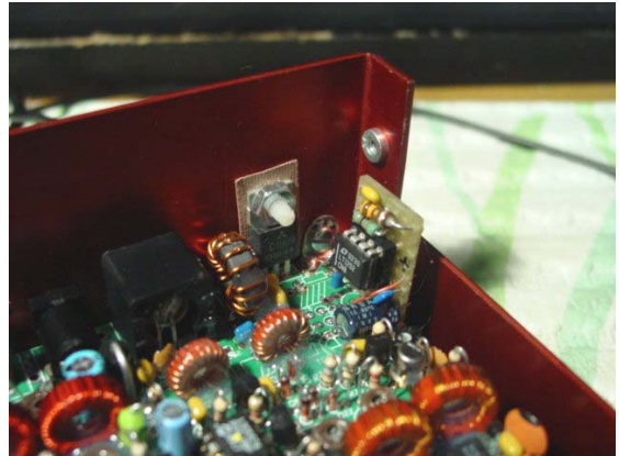
Bild 1 In Bildmitte der 2SC1969 und rechts auf dem Veroboard der Treiber mit dem Videoverstärker
