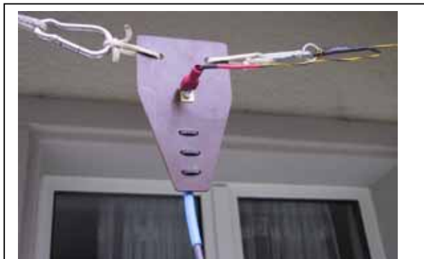
Bild 5 Leichtbauausführung des Verbindungsstücks, Seite Antennenanschluss. Die Antenne wird über einen Flachstecker angeschlossen.
