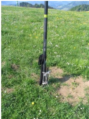
Befestigung des Fiberglasmasts am Boden
